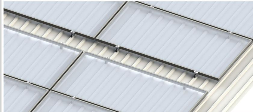
Die Thermische Trennung, der Abstand zwischen den Kurzschienen, muss mindestens 20 mm betragen (auf der selben Hochsicke).
