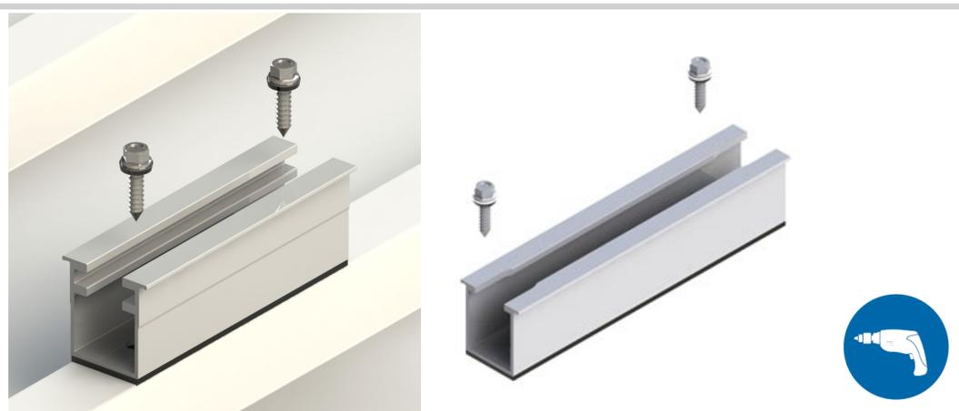
Schrauben Sie die Trapezblech-Kurzschiene mit zwei Dünnschrauben mittig und parallel auf eine Hochsicke. Beachten Sie, dass die EPDM Dichtungen unter der Kurzschiene und der Dichtscheibe der Dünnschrauben nicht mehr als 50 % komprimiert sind.
