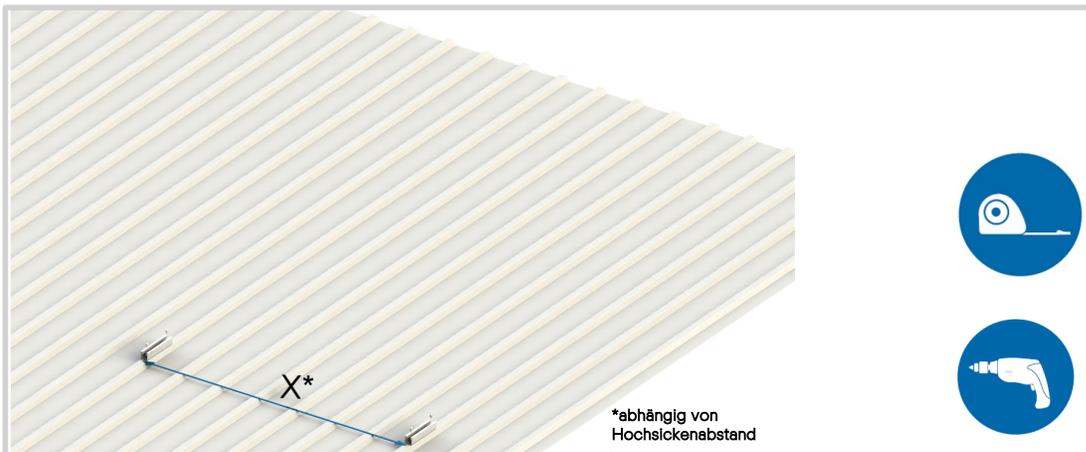
Platzieren Sie die nächste Kurzschiene so auf den nachfolgenden Hochsicken, dass der Abstand X eingehalten wird. Der Abstand X ist vom Hochsickenabstand abhängig und sollte mit dem gewählten Klemmbereich des Moduls übereinstimmen. Der Abstand X beträgt: Modullänge – 2x gewählter Klemmbereich
