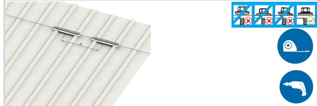
Platzieren Sie die nächste Trapezblechbrücke so auf den nachfolgenden Hochsicken, dass der Abstand x eingehalten wird. Der Abstand x beträgt: Modulbreite ( 1000 mm oder 1030 mm) + Klemmenbreite (20 mm).
