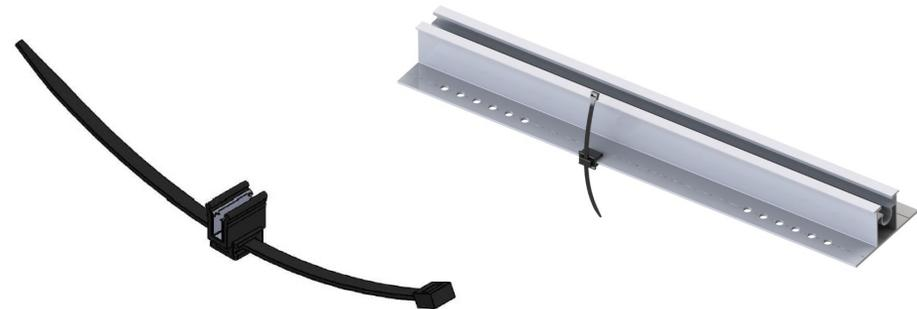
Um die Modulkabel entweder an den Rahmenseiten oder an den Trapezblechbrücken ordnungsgemäß zu befestigen, können Sie die erhältlichen Kantenclips benutzen, damit sichergestellt ist, dass die Stecker die Dachhaut nicht berühren. Wählen Sie die Position der Kantenclips so, dass die Stecker der Kabel nicht auf der wasserführenden Schicht aufliegen.
