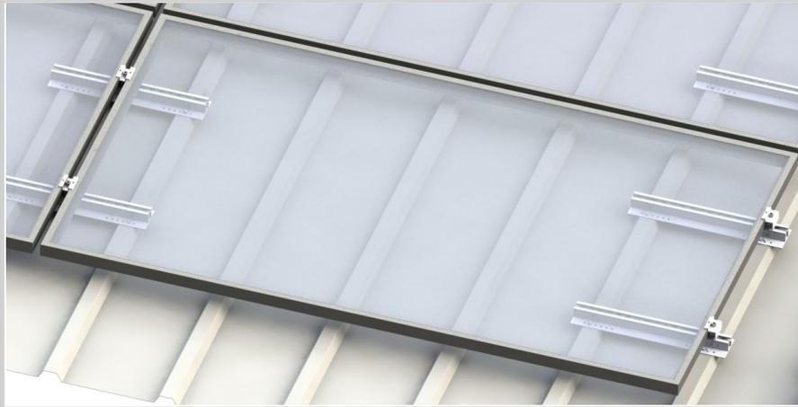
Beachten Sie die maximale Modulfeldlänge von 12 m. Nach dieser Länge muss eine Thermische Trennung der Module stattfinden.
