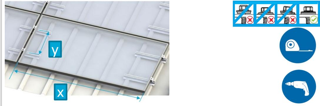
Platzieren Sie die nächste Trapezblechbrücke so auf den nachfolgenden Hochsicken, dass der Abstand x eingehalten wird. Der Abstand x beträgt: Modullänge ( 1670 mm / 1685 mm oder 1740 mm) + Klemmenbreite (20 mm).
