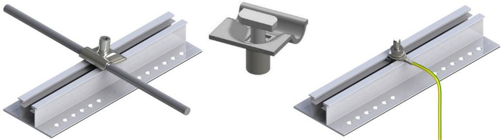
An den jeweils ersten oder letzten Trapezblechbrücken einer Modulreihe eine Drahtklemme in den Profilkanal der Trapezblechbrücken einsetzen. Den Aludraht in die Drahtklemme einlegen und durch Anziehen der Schraube befestigen. Auf diese Weise alle Modulreihen eines Modulfeldes leitend miteinander verbinden.
