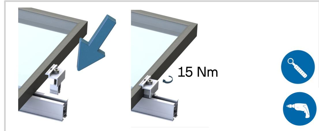
Klicken Sie die Endklemmen wie abgebildet leicht schräg in die Trapezblechbrücke und schieben die Endklemme an den Modulrahmen heran. Wenn die Klemme in der richtigen Position ist, ziehen Sie die Klemme an. Ziehen Sie die Schraube der Klemme mit einem Drehmoment von **15 Nm** an.
